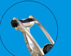
●リムアジャストメントドゥエルワッシャーによる左右アライメント調整に加えて、新たにリムのねじれ修正機構ができるようになり、更に精度の高いチューニングが可能となった。
