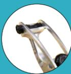
●リムアジャストメントドゥエルワッシャーによる左右アライメント調整に加えて、新たにリムのねじれ修正機構ができるようになり、更に精度の高いチューニングが可能となった。
